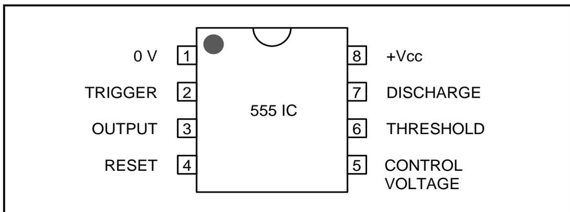
**FIGURE 4.8: 555 IC PIN LAYOUT**
