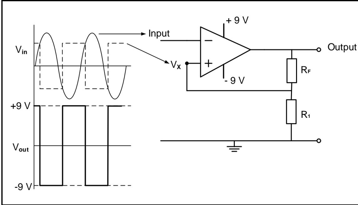
**FIGURE 5.5: SCHMITT TRIGGER**
