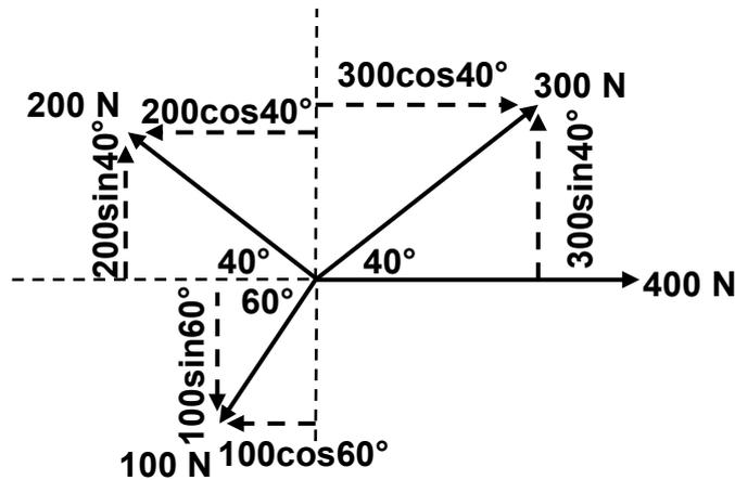
$$\begin{aligned} \sum HC &= 400 + 300\cos 40^\circ - 200\cos 40^\circ - 100\cos 60^\circ \\ &= 400 \checkmark + 229,81 \checkmark - 153,2 \checkmark - 50 \checkmark \\ &= 426,60 \text{ N } \checkmark \end{aligned}$$
